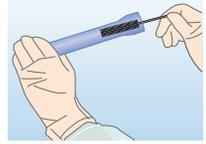
一次洗浄時、スコープ先端保護チューブを外し、内視鏡先端部とスコープ先端保護チューブを洗浄する。内視鏡先端部洗浄後は再びスコープ先端保護チューブを装着。その他の内視鏡部位をブラッシング・洗浄する。
