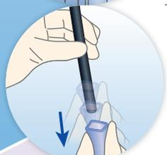
検査直前に、スコープ先端保護チューブを取り外す。
