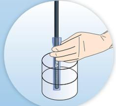
スコープ先端保護チューブを装着したまま、使用前点検を実施する。
